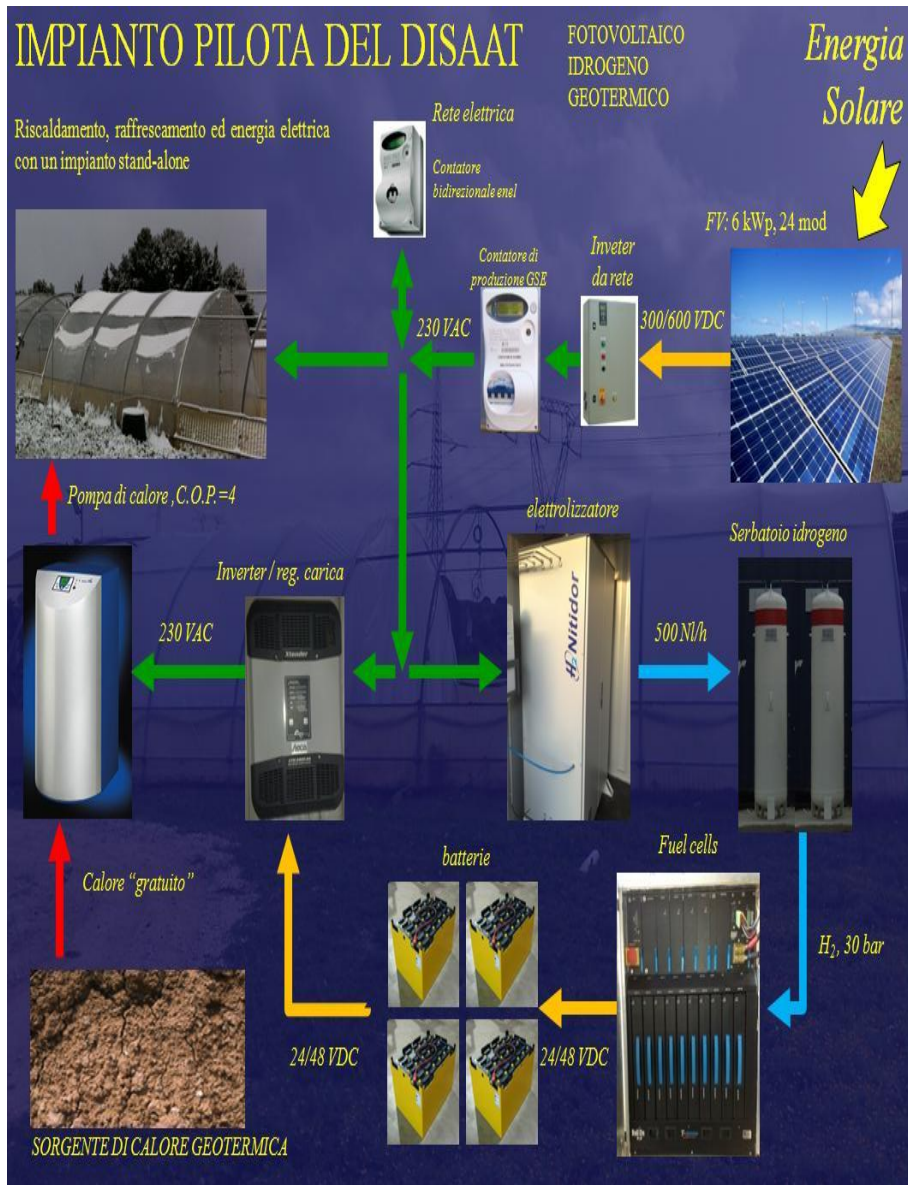
Fig. 1 - Fotovoltaico, idrogeno e geotermico integrati in un sistema stand-alone per il riscaldamento delle serre.
