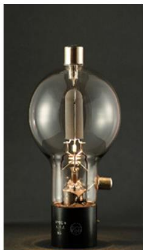
Fig. 16 Una valvola termoionica impiegata negli anni'40 [fonte Wikipedia]
